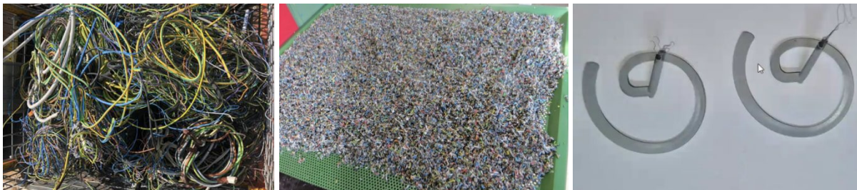
Kabelschrott, aufbereitetes Kabelmahlgut und Fließspiralen aus dem gewonnenen Rezyklat.
