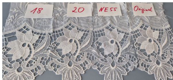
Plauener Spitze®-Prototypen aus 100 % Rezyklat gefertigt (R-PES) im Vergleich zum Original (virgin PES) nach dem Waschen
