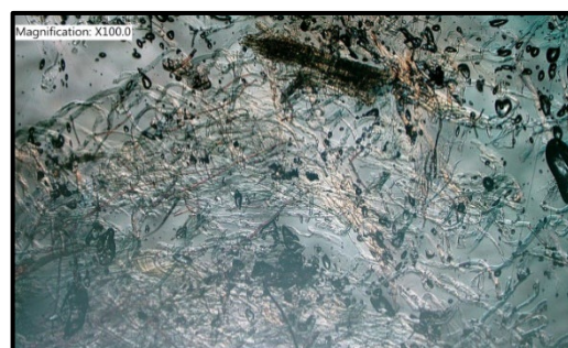
Filterbelag aus Störstoffen nach Verarbeitung einer Lösung aus Recyclingzellstoff
