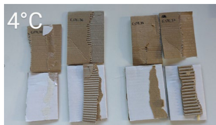
Abbildung (von links nach rechts): mit Stärkeesterfolie laminiertes Schreibpapier, Bruchversuche mit stärkeesterhaltigen Formulierung geklebter Kartonagen und Tropfenversuch auf beschichtetem Wellpappenrohpapier.
