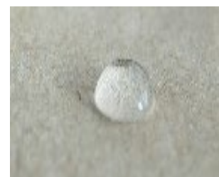
Abbildung (von links nach rechts): mit Stärkeesterfolie laminiertes Schreibpapier, Bruchversuche mit stärkeesterhaltigen Formulierung geklebter Kartonagen und Tropfenversuch auf beschichtetem Wellpappenrohpapier.
