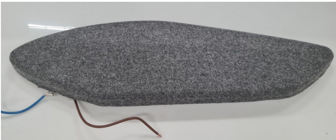
Demonstrator mit integrierter Heizstruktur gefertigt im One-Shot-Prozess
