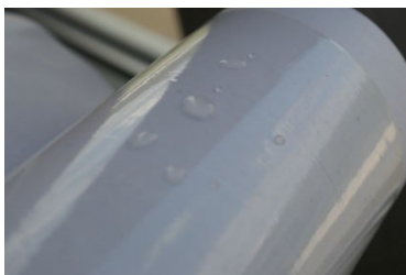
Abbildung (von links nach rechts): mit Stärkeesterfolie laminiertes Schreibpapier, Bruchversuche mit stärkeesterhaltigen Formulierung geklebter Kartonagen und Tropfenversuch auf beschichtetem Wellpappenrohpapier.
