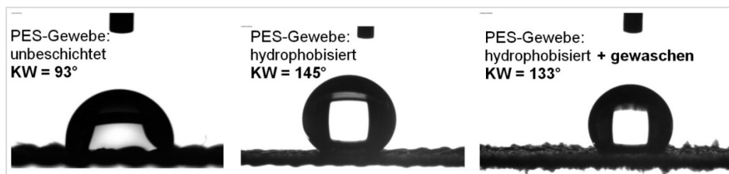
Fotos von Kontaktwinkelmessungen mit aufgesetztem Wassertropfen. Links: Gewebe (Polyester, PES) unbeschichtet (nach Reinigung); Mitte: mit neuem, im Vorhaben hergestelltem M3T-Oxazolin beschichtetes PES-Gewebe; rechts: mit neuem, im Vorhaben hergestelltem M3T-Oxazolin beschichtetes PES-Gewebe nach 15x Wäsche bei 60^\circ\text{C} /90 min (DIN 53920).
