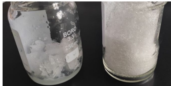
Ergebnis der radikalischen Massepolymerisation von unvernetztem Polybehenylmethacrylat (links) sowie Ergebnis der Emulsionspolymerisation zur Herstellung von unvernetztem ff-Polybehenylmethacrylat (rechts)
