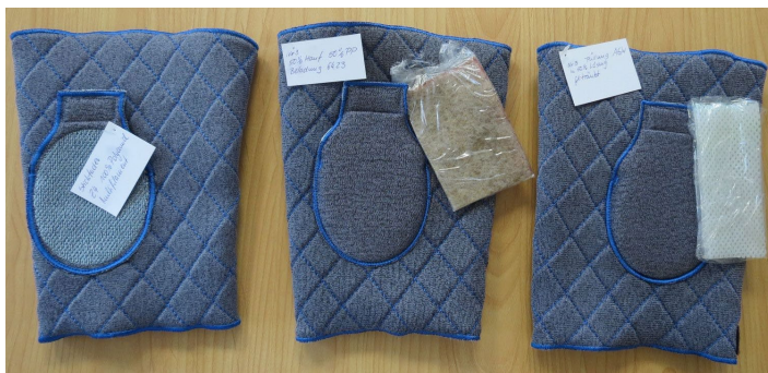
Abb. 1: Design und Fertigung eines Prototypen – eines Protektors fürs Knie: links - bestickt mit dilatant gefülltem Garn aus Multifilamenten (50 % dilatantes Fluid/ 50 % Polyamid 6); Mitte und rechts – zwei verschiedene, mit dilatantem Fluid beladenen mechanisch flexible, textile Flächen (Gewebe, Vlies) als Protektor-Pads zum Einschub in die wiederverschließbare Tasche
