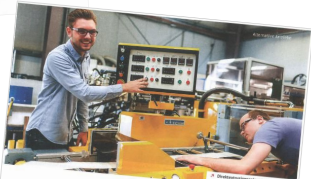
Direktextrusionsanlage zur Herstellung endfaserverstärkter Thermoplaste
