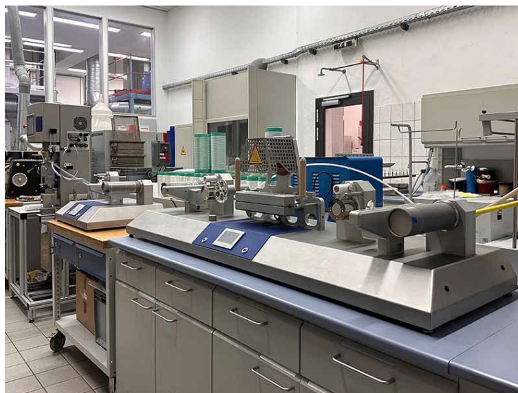
Der Microcompounder mit Extrusionseinheit, Wickler und Verstreckeinheit (v.l.n.r.).
