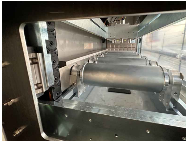
Blick in einen Teil der Faserbereitstellungs- und Spreizanlage.
