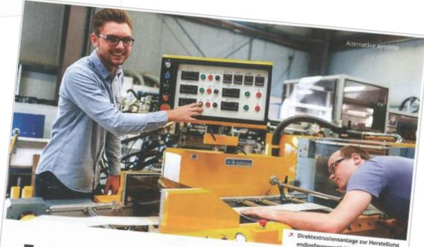
Direktextrusionsanlage zur Herstellung endfaserverstärkter Thermoplaste
