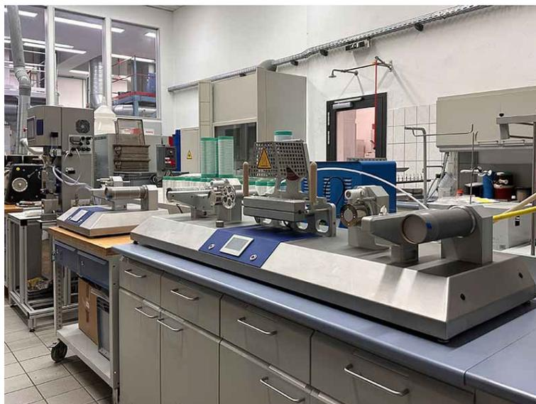
Der Microcompounder mit Extrusionseinheit, Wickler und Verstreckeinheit (v.l.n.r.).
