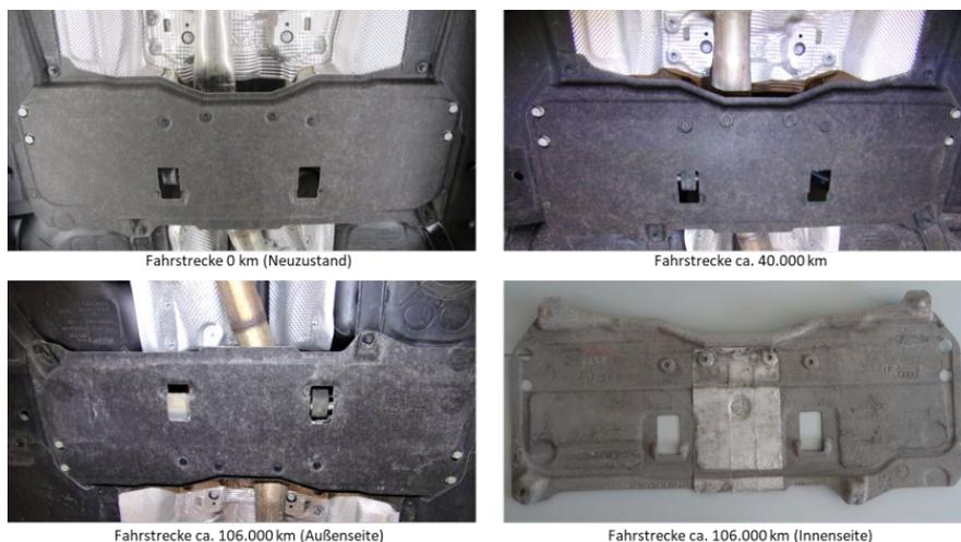
Bild 1: Unterbodenteil mit Naturfaserverstärkung nach dem Dauertest
