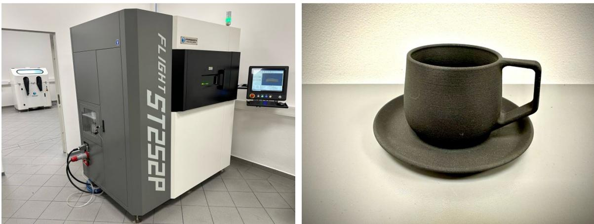
Abbildung 3: Farsoon Flight ST252P, SLS-gedruckte Tasse/Untertasse
