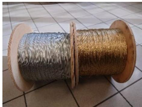
Bild 2: Verzinkte und vermessingte Stahlseil-Litze
