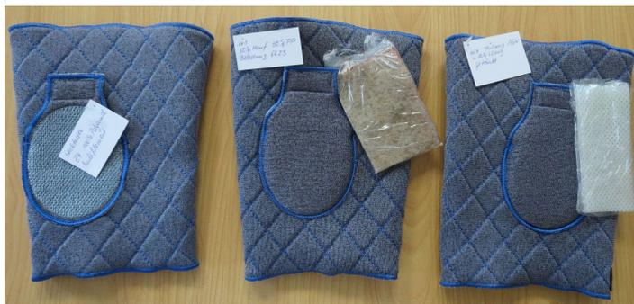
Abb. 1: Design und Fertigung eines Prototypen – eines Protektors fürs Knie: links - bestickt mit dilatant gefülltem Garn aus Multifilamenten (50 % dilatantes Fluid/ 50 % Polyamid 6); Mitte und rechts – zwei verschiedene, mit dilatantem Fluid beladenen mechanisch flexible, textile Flächen (Gewebe, Vlies) als Protektor-Pads zum Einschub in die wiederverschließbare Tasche
